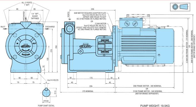
PUMP WEIGHT: 19.5KG PUMPSET WEIGHT: 19.5KG + MOTOR WEIGHT
